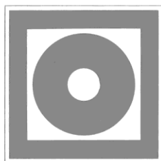
Кнопка включения установок (систем) пожарной автоматики
